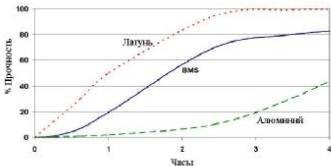
Время затвердевания рассматривается обычно при 23°C. Меди и ее сплавам соответствует более быстрое затвердевание, чем окисленным или пассивным поверхностям, таким как нержавеющая сталь, которая имеет тенденцию к более медленному затвердеванию. Чем ниже температура или чем шире зазор, тем больше времени затвердевания. Для сокращения времени затвердевания можно либо использовать [Permabond A905](#), либо высокую температуру, по выбору.
